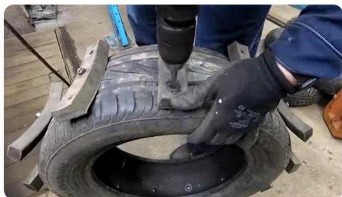
Сверлим боковые отверстия и ставим болты м8 50мм с двумя гайками
